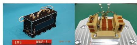
Fig. 3 「あらせ」衛星に搭載した磁力計<sup>4)</sup>。左: 回路部、右: センサ部
