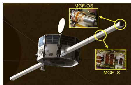
Fig. 1 水星探査計画 BepiColombo 「みお」衛星と搭載磁力計センサ (衛星の図は JAXA 提供)
