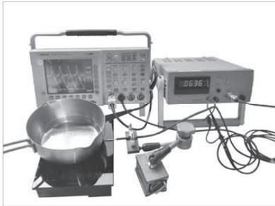
測定例：電磁調理器の漏れ磁場測定
