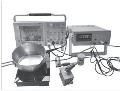
測定例:電磁調理器の漏れ磁場測定
